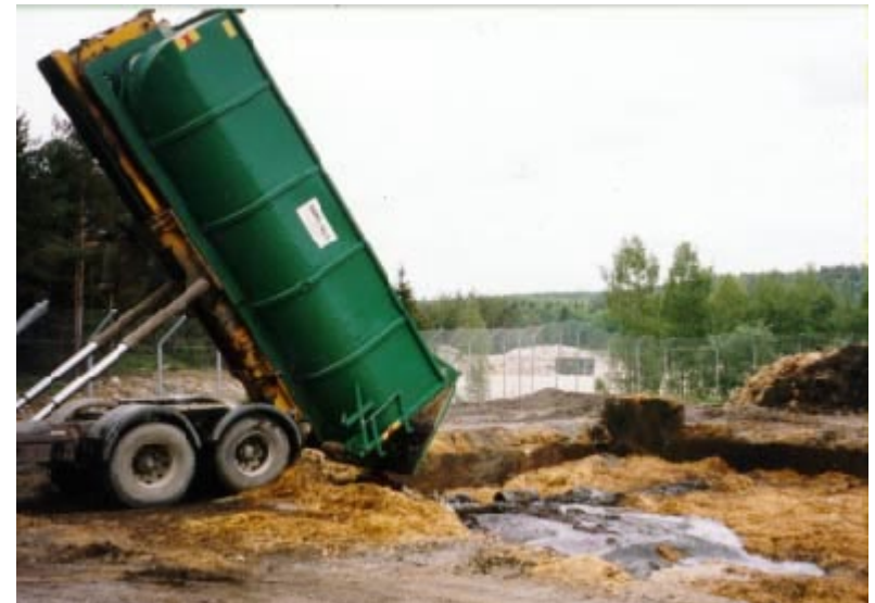
Figur 1. Inkommande oljehaltigt avfall, i detta fall glödska-slamm, töms i cementbassängen.
